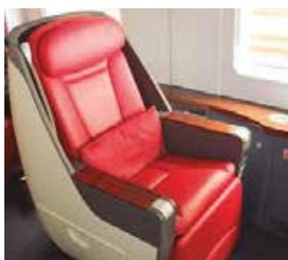
Cadeira VIP para comboio de alta velocidade fabricada usando Crestapol® 1212
